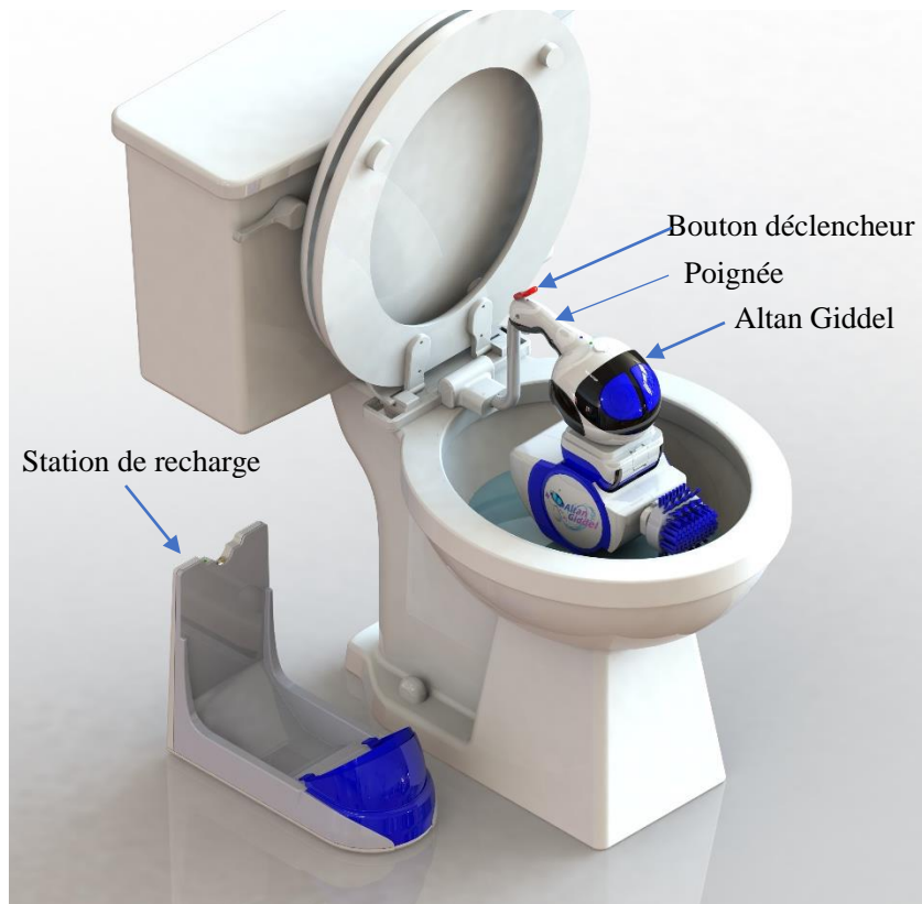
Figure 7 : Altan Giddel monté sur une toilette en position d'origine
